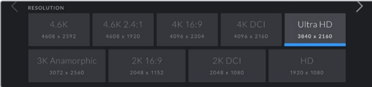
'Resolution' options on URSA Mini Pro 4.6K G2 and URSA Mini Pro 4.6K cameras
