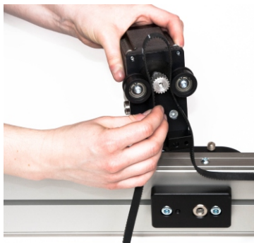
Зубчатая лента, установленная правильным образом
