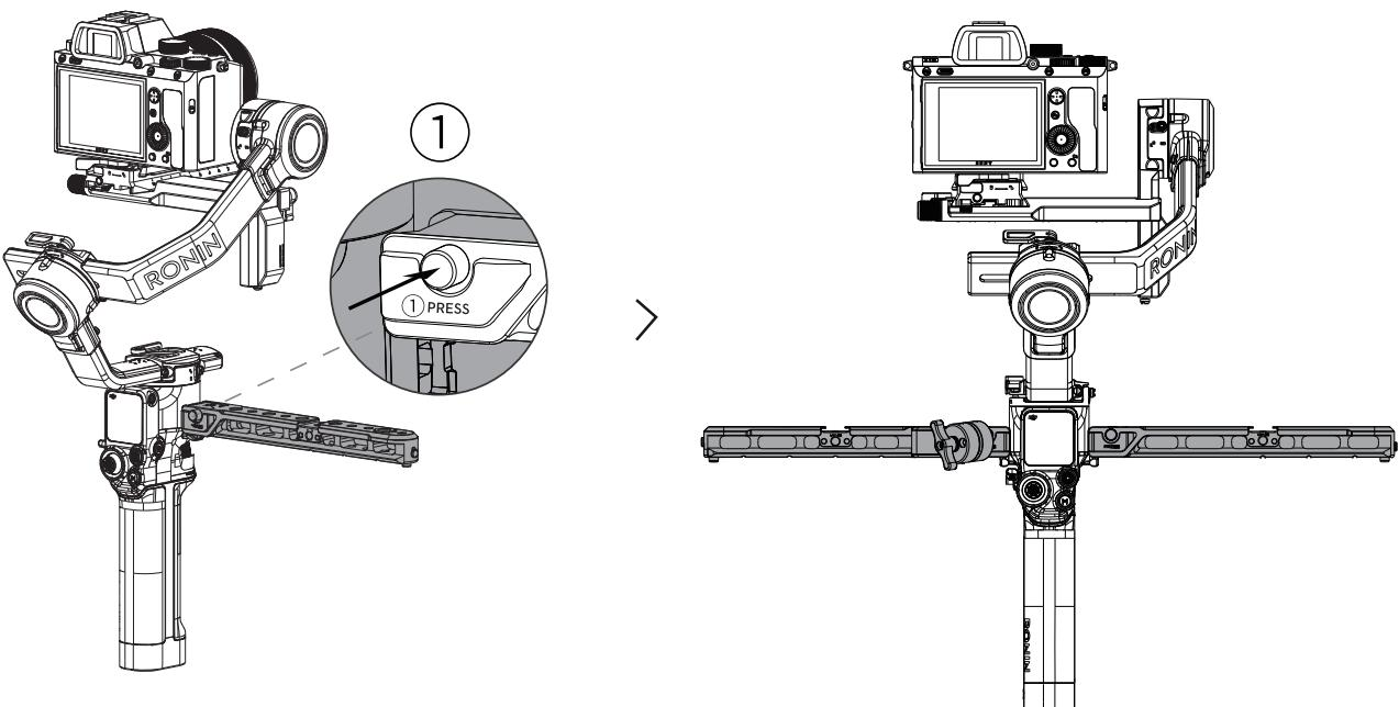
2. Installieren Sie den Doppelgriff an der linken und rechten Querstange, ziehen Sie die zu befestigenden Knöpfe fest und achten Sie auf die Montagerichtung des Doppelgriffs auf.
