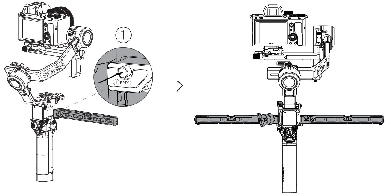
2. Si prega di Installare le impugnature sul braccio sinistro e destro, serrare le impugnature per fissarle, prestare attenzione alla direzione di installazione delle impugnature su entrambi i lati.
