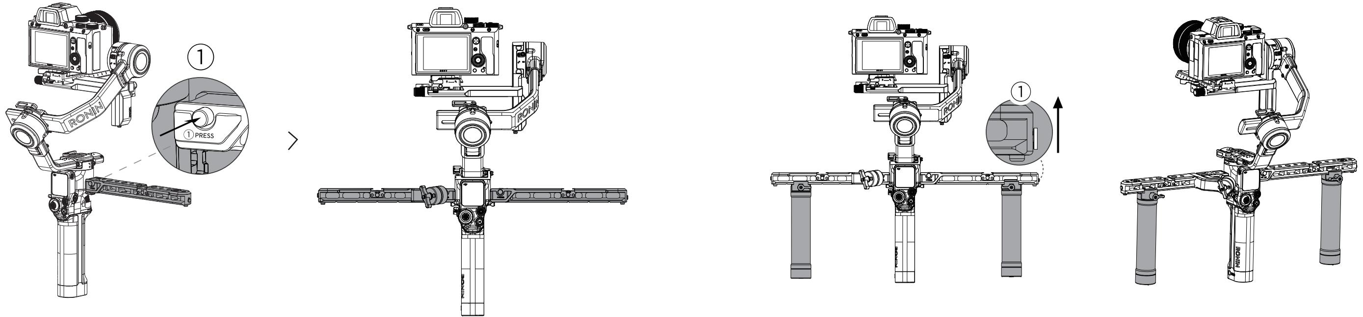
2. Instale grips de alça nos braços de extensão esquerdo e direito, e aperte o botão para os fixar. Observe direção de instalação dos grips em ambos lados.
