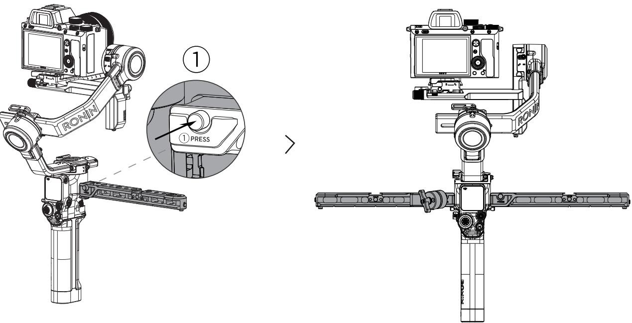
2. Instale punhos de alça nos braços de extensão esquerdo e direito, e aperte o botão para os fixar. Observe direção de instalação dos punhos em ambos lados.
