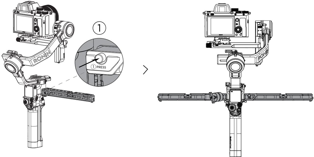
2. Installer les poignées sur les bras d'extension gauche et droite, serrer les boutons pour les fixer, faire attention au sens d'installation des poignées des deux côtés.
