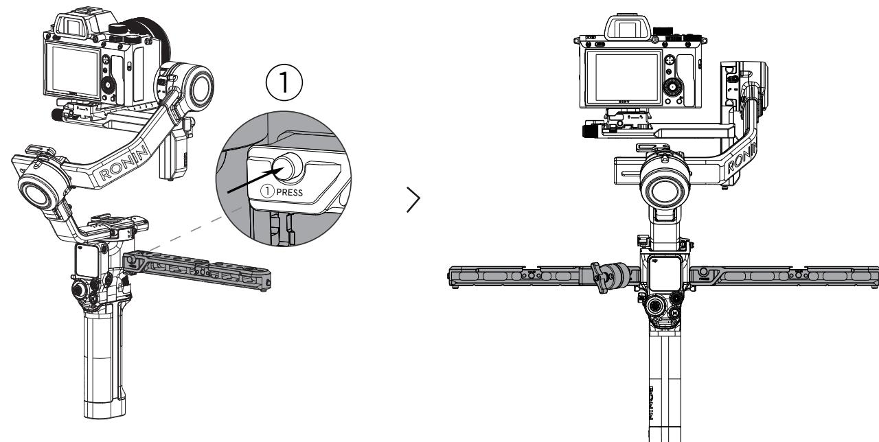
2. Установите контроллер на левую и правую поперечины, за
