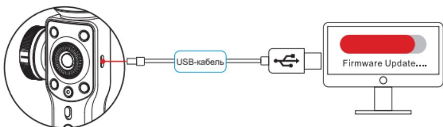
Для обновления программного обеспечения и калибровки подключите стабилизатор к компьютеру с помощью кабеля micro-USB.
