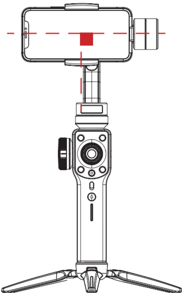
⚠ Правильно выполненная настройка центра тяжести обеспечивает оптимальное потребление энергии во время использования стабилизатора. Неправильно настроенный центр тяжести не влияет на функционирование стабилизатора, но может привести к повышенному потреблению энергии моторами и снижению их производительности.
