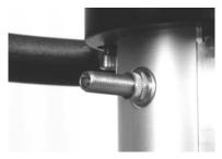
das Ventil setzen. Einige Male pumpen, bis die Säule wieder in jeder Stellung stehen bleibt. Ein Sicherheitsventil ist geräteseitig vorhanden und verhindert ein Überfüllen der Säule.
