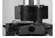
Da die Luftfeder der Säule bereits werksseitig aktiviert wurde, kann die Säule bereits jetzt selbsttätig ausfahren. Den Druck können Sie am Manometer ablesen.
