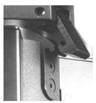
Befestigen Sie den Kopf, indem Sie alle 3 Schrauben mit dem mitgelieferten Inbusschlüssel Gr. 4 festziehen. Stellen Sie sicher, daß der Kopf gut befestigt ist.
